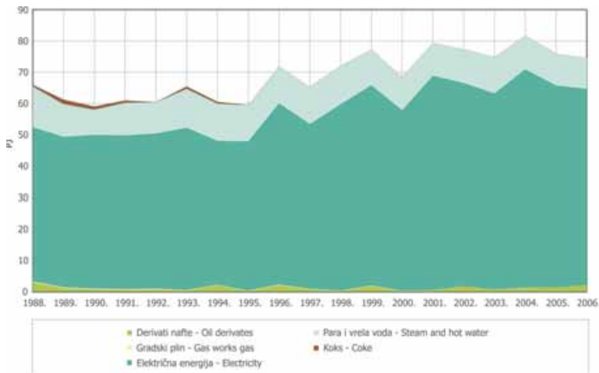
Slika 2.7.1. Gubici u proizvodnji transformiranih oblika energije
